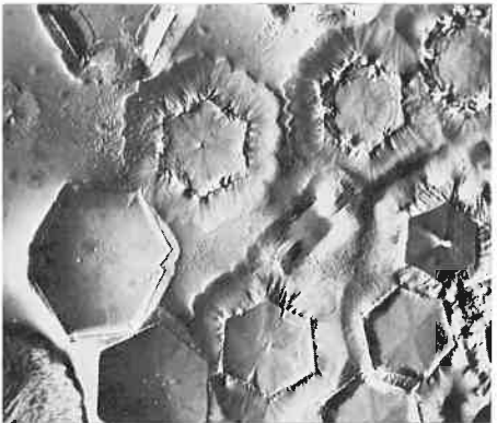
Dévitrification à la surface d'un verre au plomb (Réplique) Cliché Institut d'Optique - PARIS
